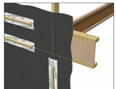
Klemming av skjøter m/tape
