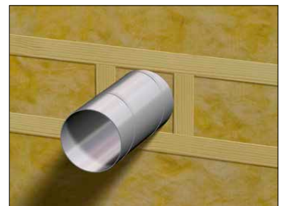
Kubbing rundt gjennomføringer
