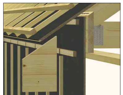
Overgang vegg/tak med løst utstikk
